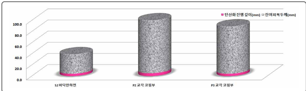
[그림 4.2.3] 탄산화깊이 및 잔여피복두께 측정결과
